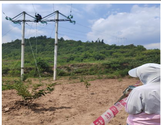
野外探伤验收现场照片(探伤机主射向上)
